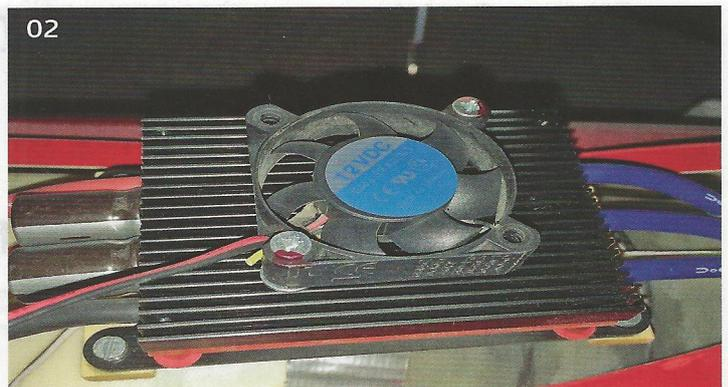
01 | Pulsweitenmoduliertes Drehstrom-Brücke mit Mittelwert (Phasem A) 02 | Lässt sich auch selber umbauen: Ein Regler mit aufgesatteltem CPU-Lüfter
