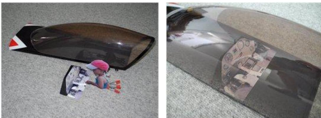
Ich fertige aus Balsaholz ein Armaturenbrett und drucke ein Foto des Sbach 300 Cockpits korrekt dimensioniert auf Fotopapier aus. Als Pilot drucke ich zwei Foto meiner Tochter aus,
