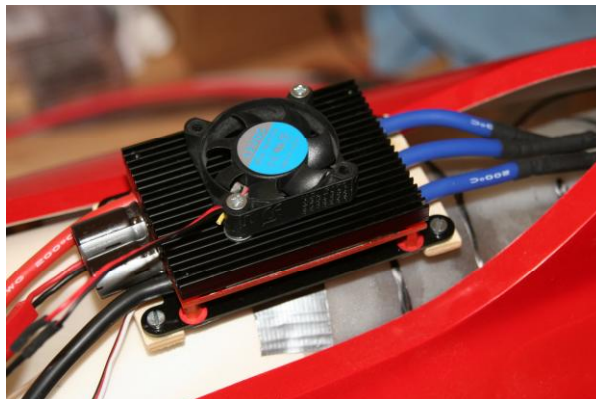
120A-Regler mit Rippenkühlkörper und zusätzlichem CPU-Lüfter
